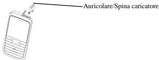
Durante la ricarica, l'icona della capacità della batteria sullo schermo lampeggia da destra a sinistra. Una volta che la batteria è completamente carica, l'icona mostra tutte le barre. Un leggero riscaldamento durante la ricarica è assolutamente normale.
