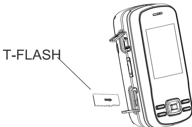
Installazione della T-FLASH Card: liberare il bloccaggio della T-FLASH card, inserire la card nello slot, quindi lo schermo mostrerà “Scheda di memoria inserita”. Bloccare la card, e l’installazione è a questo punto conclusa.
