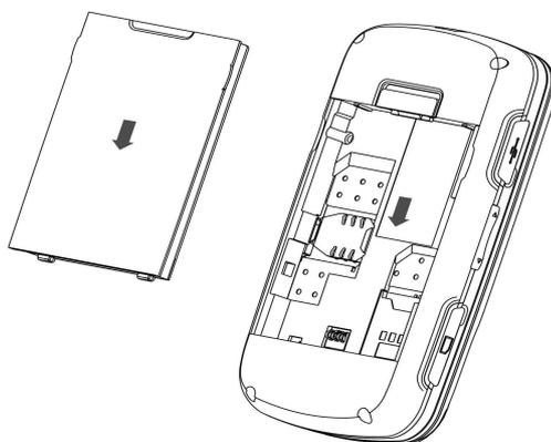
**Nota:** installare la batteria come mostrato nel diagramma per evitare che la placca di contatto della batteria venga danneggiata.
